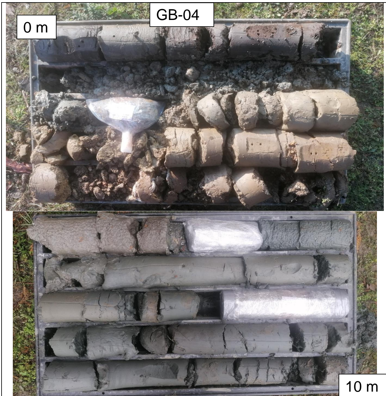
Slika 23. Bušotina GB-04 – Fotografija jezgre (0,00-10,00 m)
