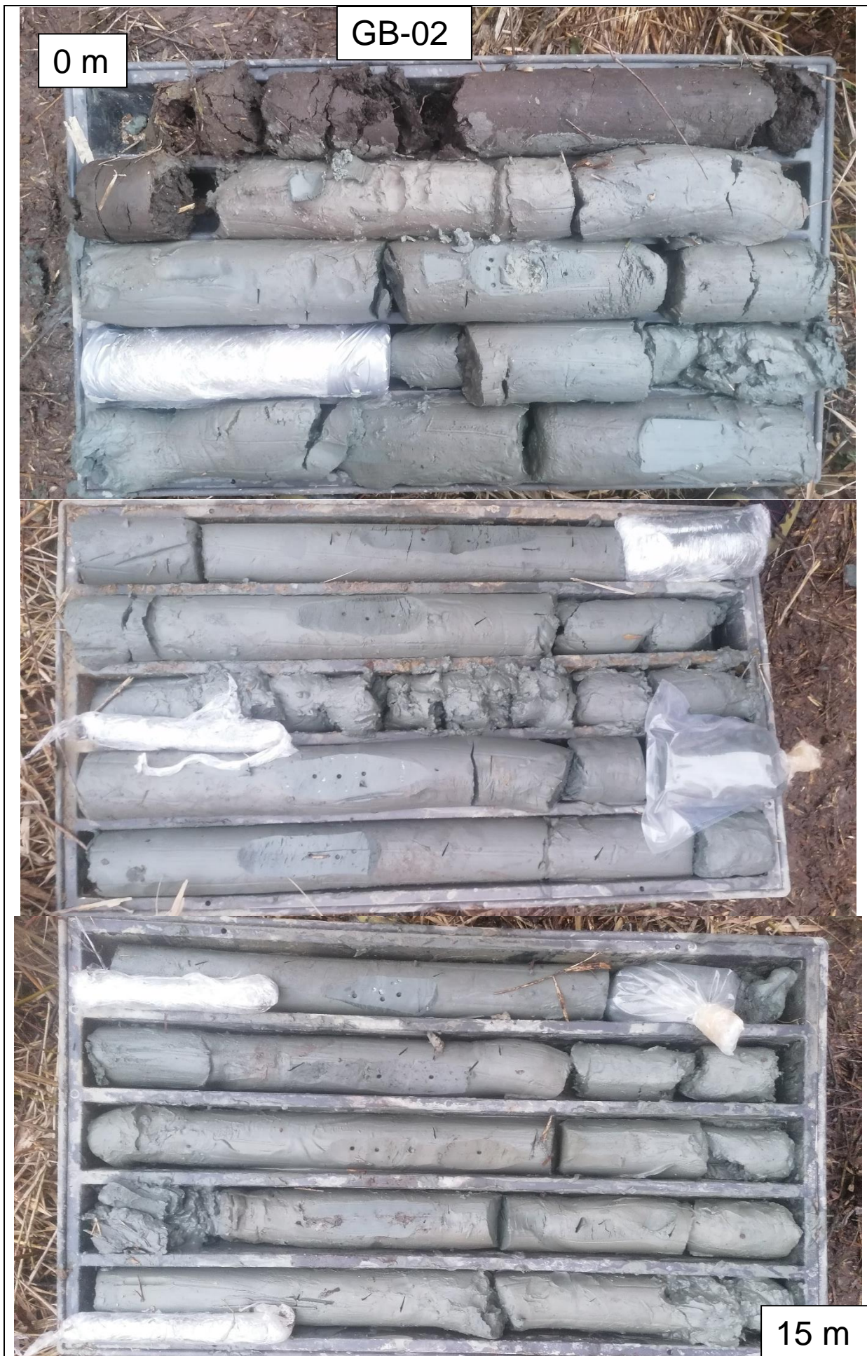
Slika 20. Bušotina GB-02 – Fotografija jezgre (0,00-15,00 m)
