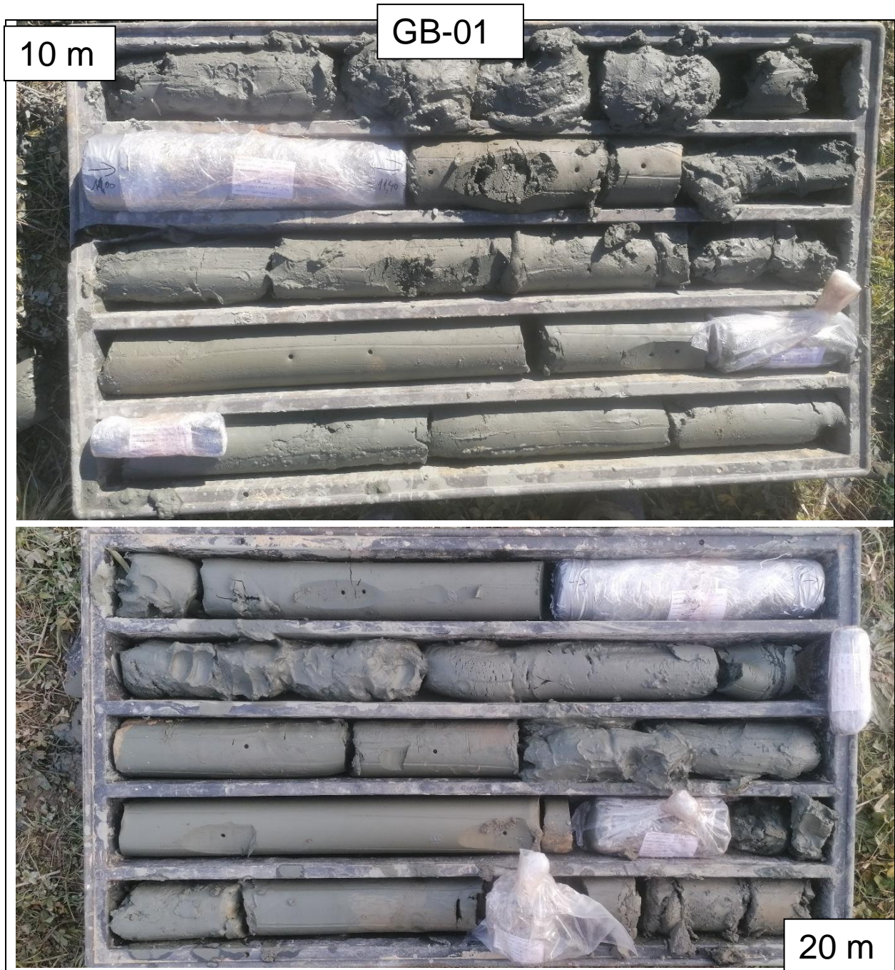
Slika 19. Bušotina GB-01 – Fotografija jezgre (10,00-20,00 m)
