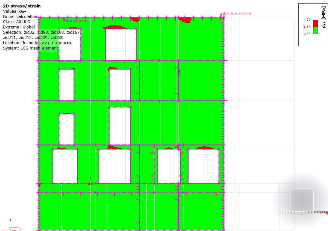
Prikaz vlačnih naprezanja promatranog zida za ukupnu anvelopu potresnih kombinacija - model 2A
