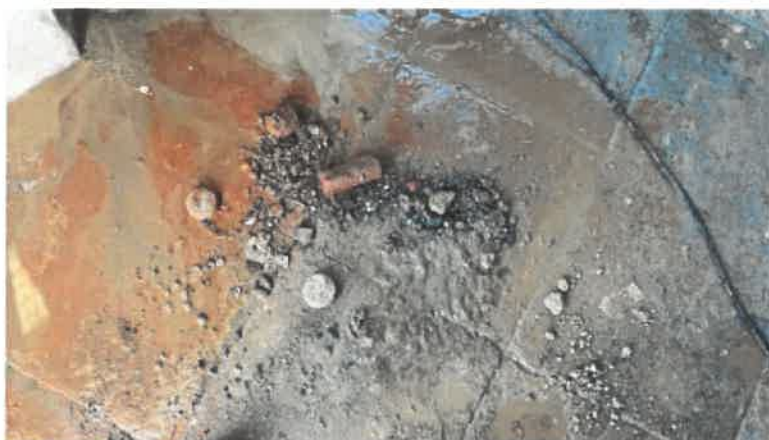
Slika 3 Materijal izvađen bušenjem zidanih elemenata
