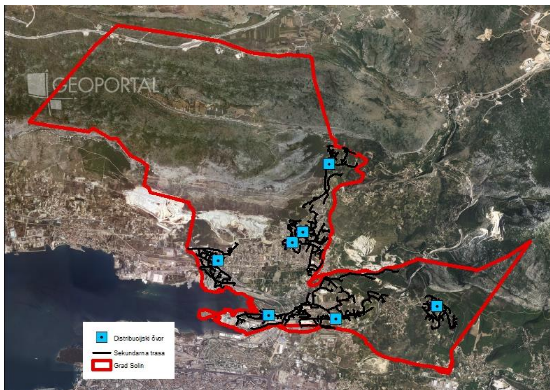
Slika 3 Planirano područje pokrivanja svjetlovodnom mrežom u Gradu Solinu
