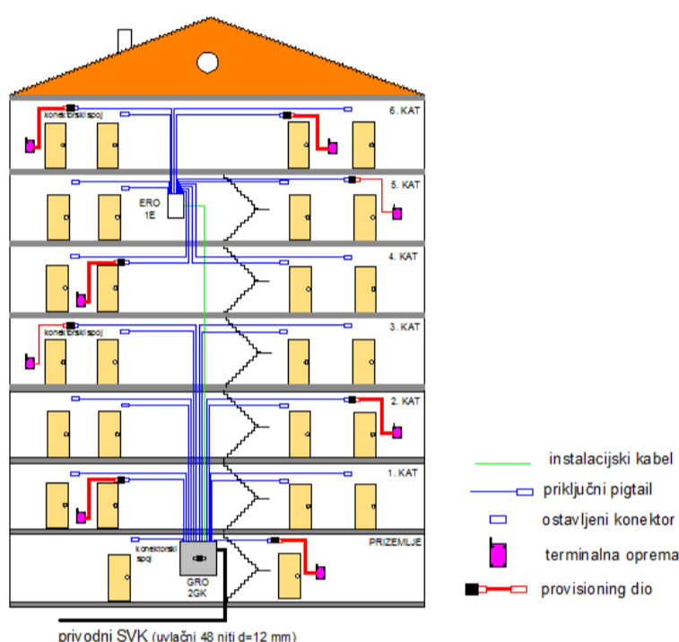
Slika 40. – korisnička vertikala u većoj stambenoj zgradi
