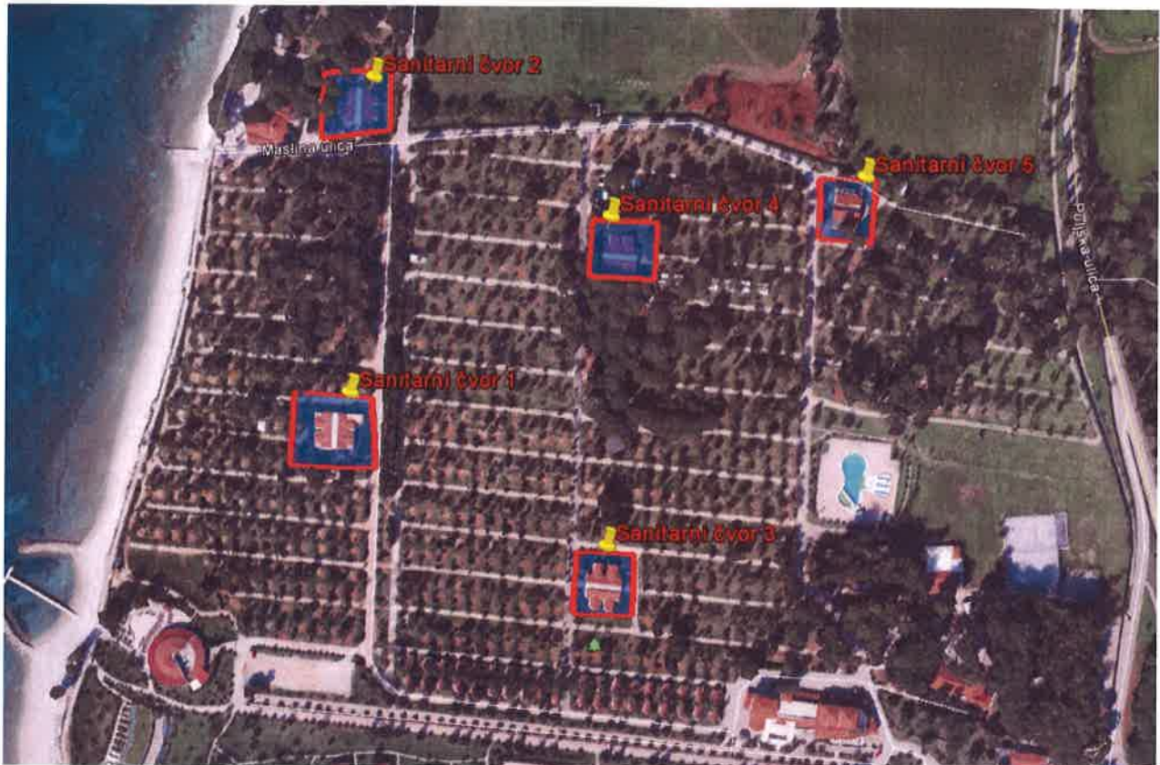
Slika 3. Zone obuhvata (označene crvenom bojom) namjenjene za proizvodnju toplinske energije iz obnovljivih izvora energije – sunce, ugradnjom solarnih toplovodnih panela za proizvodnju potrošne tople vode za vlastite potrebe za sanitarne čvorove naselja
