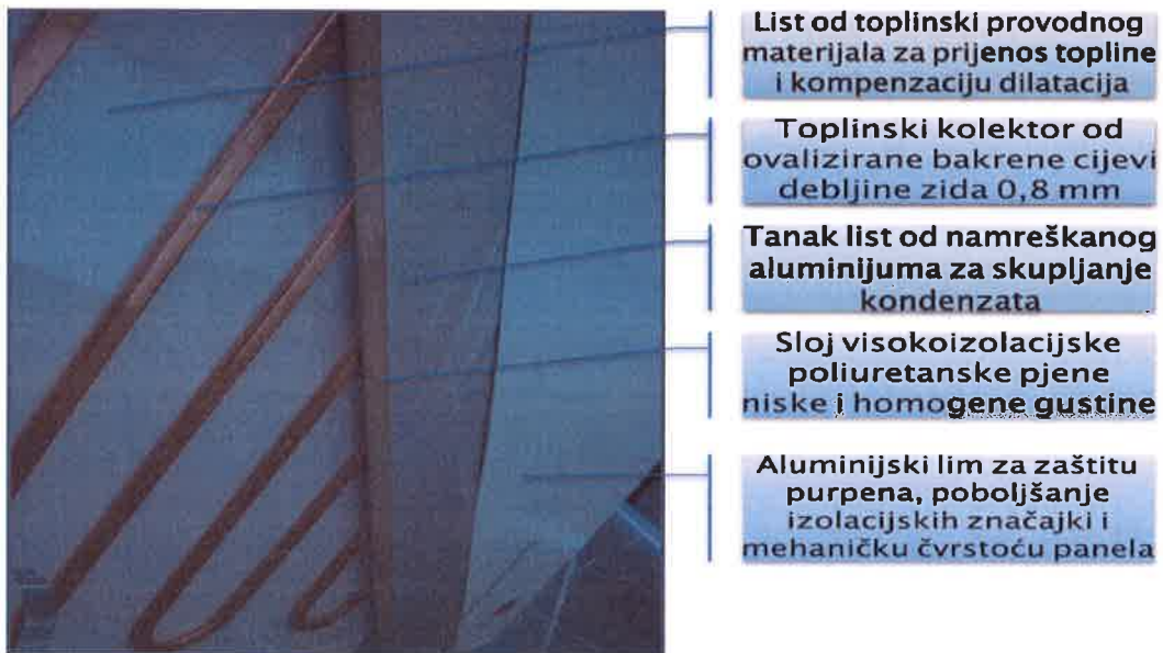
Slika 5. Naponsko-toplinski ili PVT sunčev kolektor - takozvani hibridni proizvod koji na poleđini foto-naponskog ili PV (anglosaksonski: Photo-Voltaic) kolektora ima dograđen bakreni ili aluminijski toplinski kolektor kroz koji protječe voda ili neki drugi fluid
